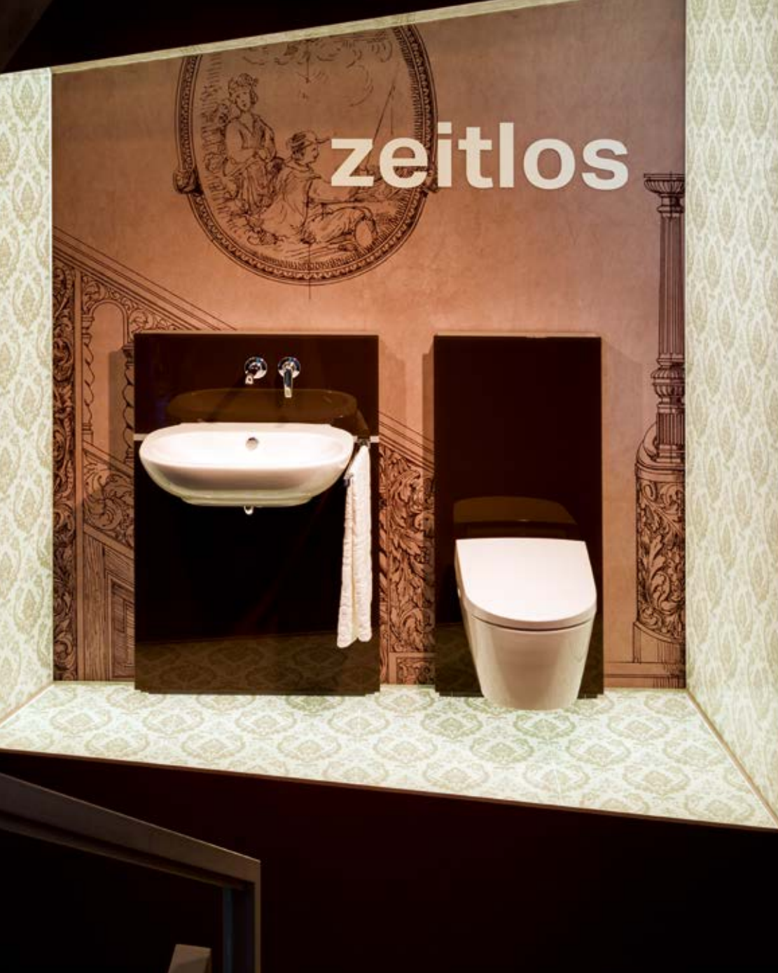
Dekorativer Blickfang im Treppenhaus der Geberit Gruppe in Rapperswil. Tapete im Verbund mit zwei 10 mm Einscheibensicherheitsgläsern (ESG), hinterleuchtet. Diese Ausführung ist auch für Fluchtwege einsetzbar.
