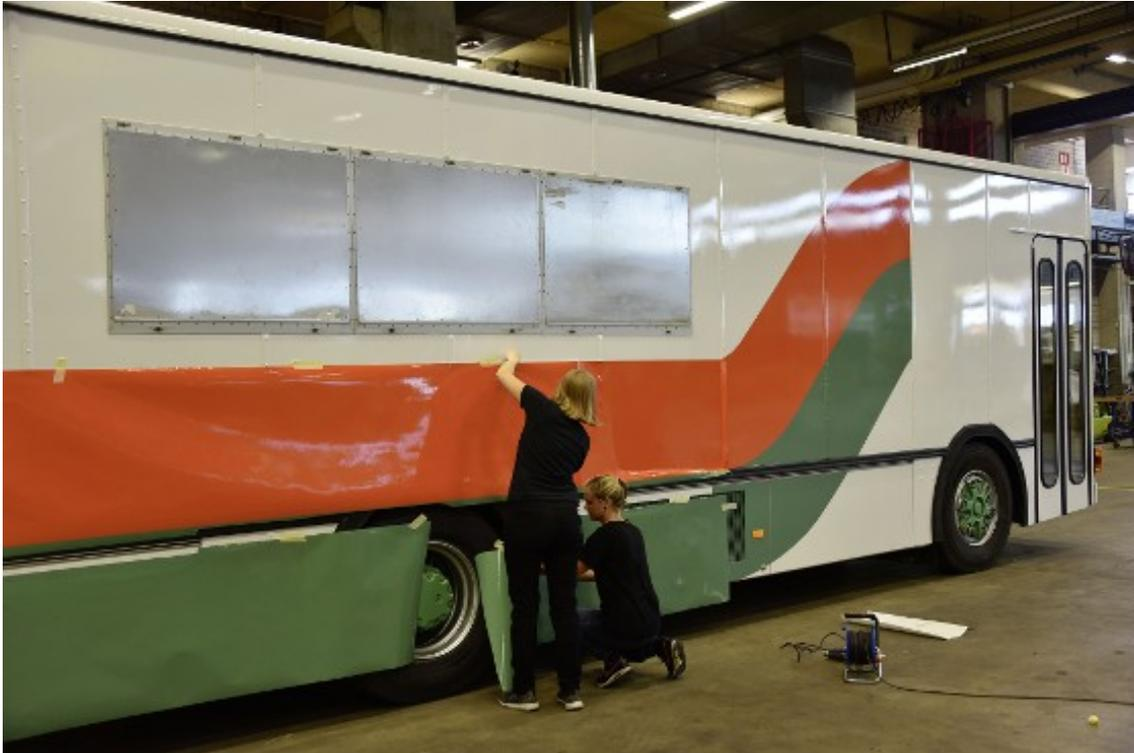
2/4 Dann wurde der orange - grüne Doppelstreifen auf Folie aufgeklebt (Bild: 2communicate).
